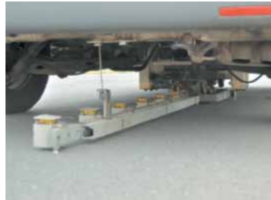
Bild 10: Einsenkungsmessung mit Falling-Weight-Deflectometer (FWD)
