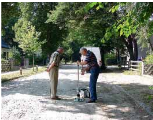
Bild 8: Bestimmung des dynamischen Verformungsmoduls E_{vd} mit dem Leichten Fallgewichtsgerät
