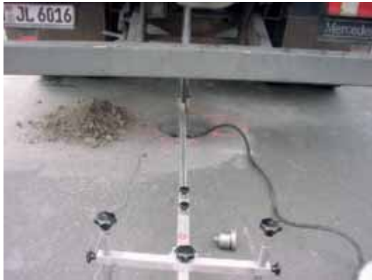
Bild 7: Bestimmung des statischen Verformungsmoduls E_{v2} im Bohrloch auf der alten ungebundenen Tragschicht
