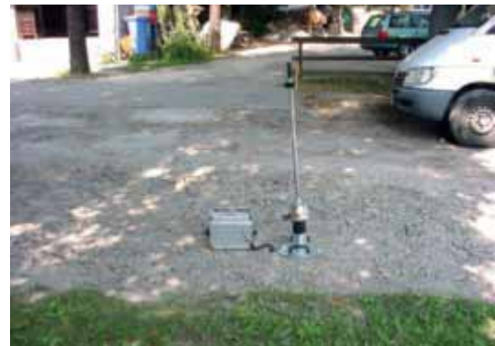
Bild 16: Tragfähigkeitsmessung mit dem Leichten Fallgewichtsgerät in einem Schlagloch der alten sandgeschlämmten Schotterdeckschicht vor der Verfüllung ( E_{vd} = 60 \text{ MN/m}^2 )
