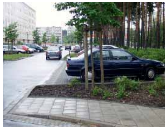
Bild 9: Senkrechtstellplätze, dazwischen Gehwegvorstreckungen mit Querungshilfen (Eberswalde)
