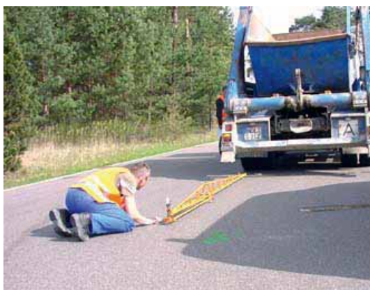
Bild 9: Einsenkungsmessung mit Benkelman-Balken auf flexibler Befestigung
